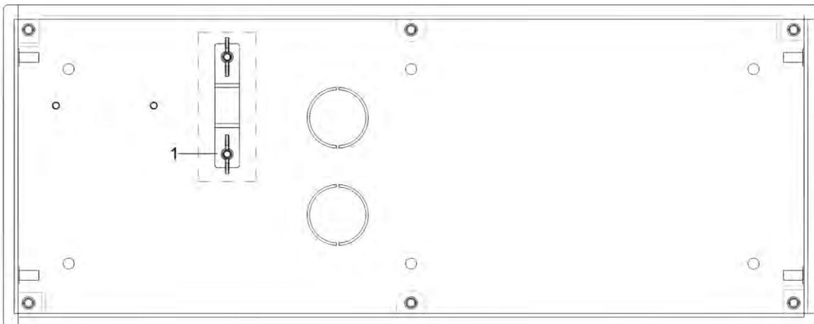
Stellen Sie bei horizontaler Montage sicher, dass der Sabotageschalter auf der Rückseite (in Abbildung 3 4 mit "1" gekennzeichnet) gedrückt ist, sodass bei Manipulation an der Außenstation der Alarm Alarm ausgelöst wird Ausgelöst.
