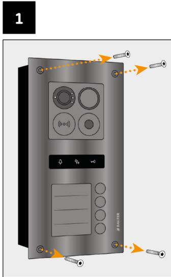
Entfernen Sie alle Befestigungsschrauben.
