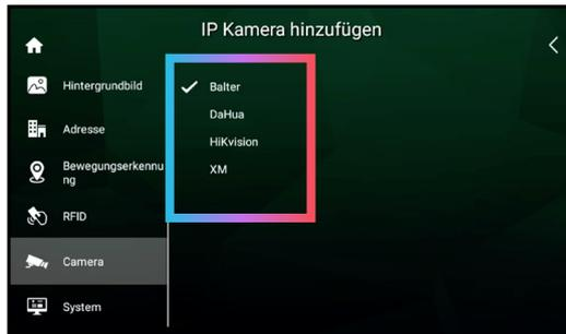
Wenn Sie eine BALTER Kamera anschließen, tippen Sie auf „**Balter**“. Wenn Sie eine NEOSTAR oder HiLook Kamera anschließen, tippen Sie auf „**HiKvision**“.
