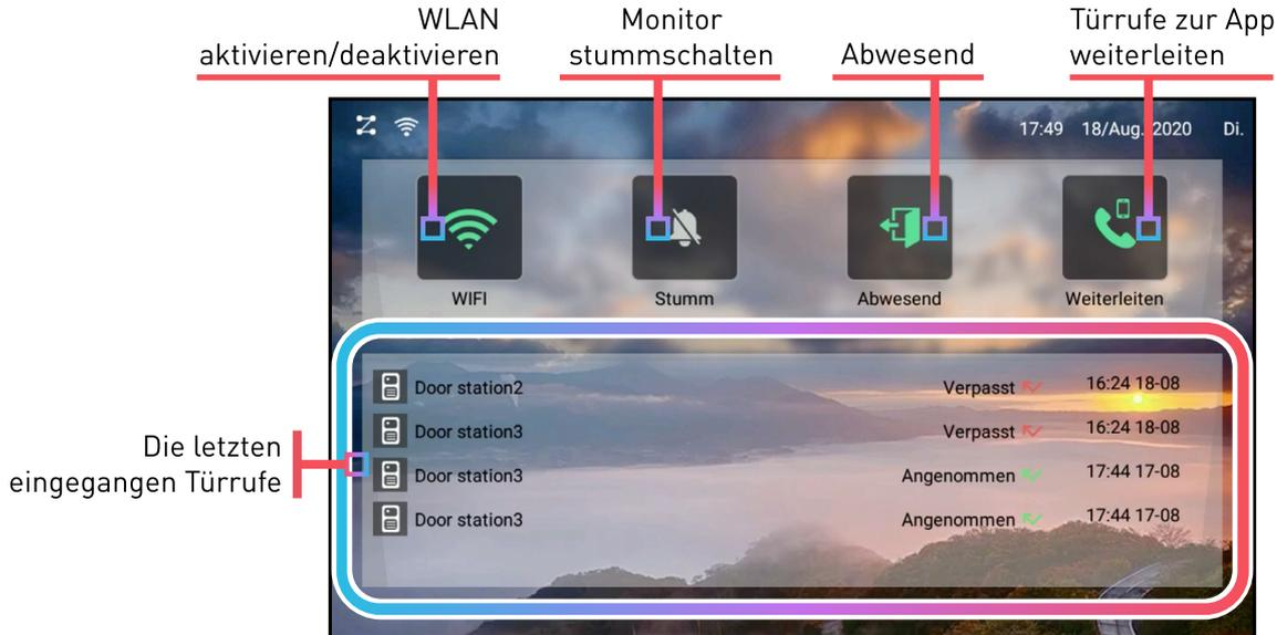
**WLAN aktivieren/deaktivieren:** Diese Funktion kann nur genutzt werden, wenn der Monitor bereits mit dem WLAN verbunden wurde (Siehe Seite 34).
