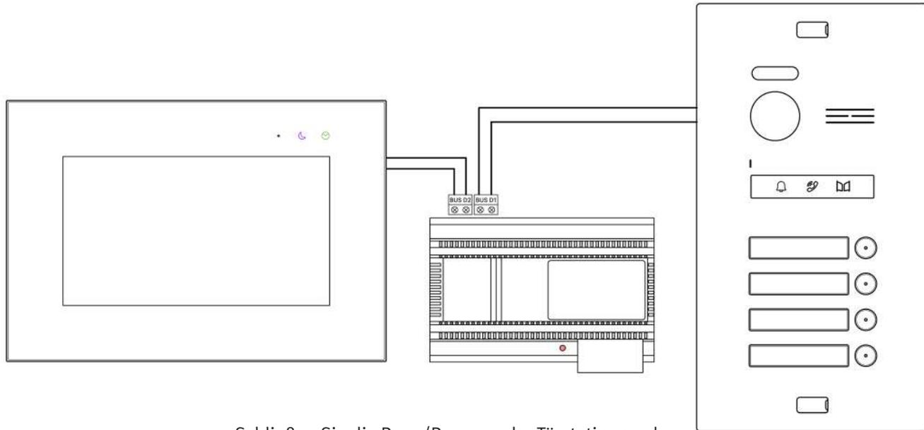
Schließen Sie die Bus+/Bus- von der Türstation an den D1 Anschluss und die Bus In vom Monitor an den D2 Anschluss des Netzteils an.
