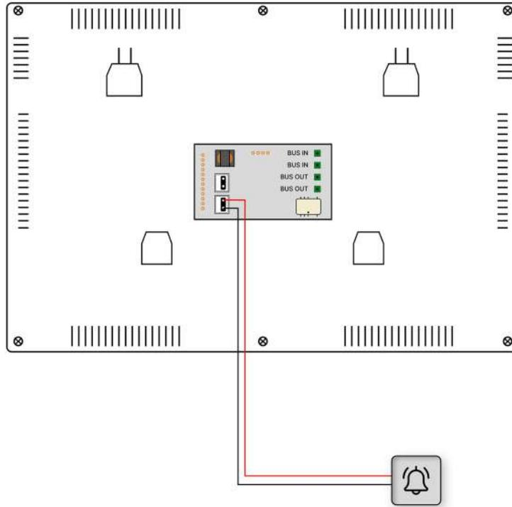
Schließen Sie den Stecker in die "GND/DOORBELL" Buchse und verbinden Sie die Kabel mit Ihrer Etagen Klingel.
