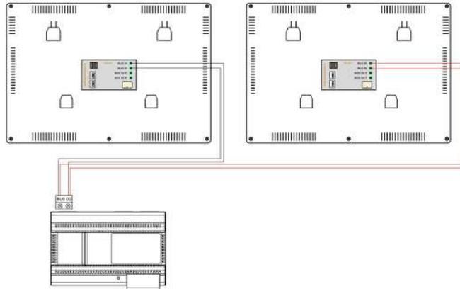
Im Diagramm sehen Sie ein Beispiel für die Sternverdrahtung. Jedes Gerät wird separat an das Netzteil angeschlossen.
