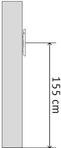
Montieren Sie den Monitor etwa auf Augenhöhe. Probieren Sie im Zweifel verschiedene Montagehöhen aus, bevor Sie den Monitor fest anbringen, um spätere Korrekturen zu vermeiden. Unsere Empfehlung ist 1,55m
