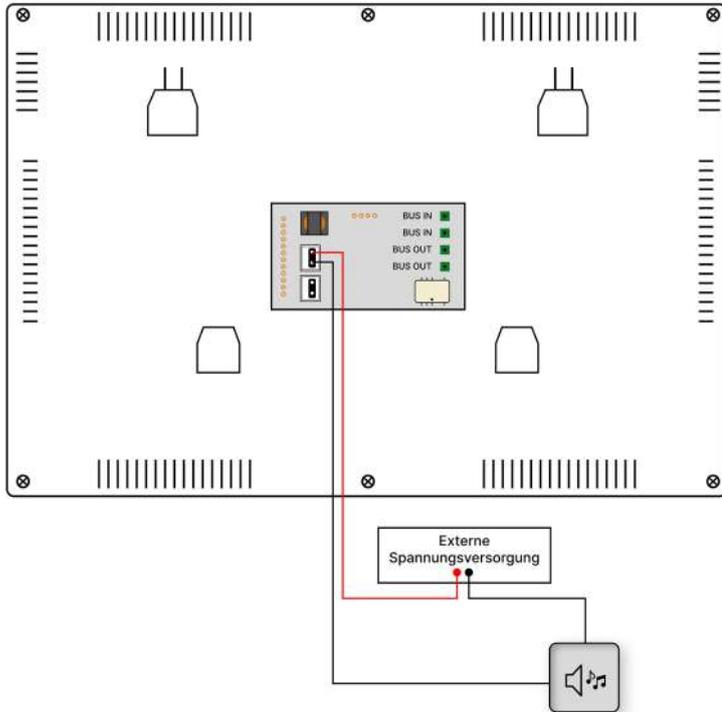
Schließen Sie den Stecker in die "NO/COM" Buchse und verbinden Sie die Kabel mit Ihrem externen Gong.
