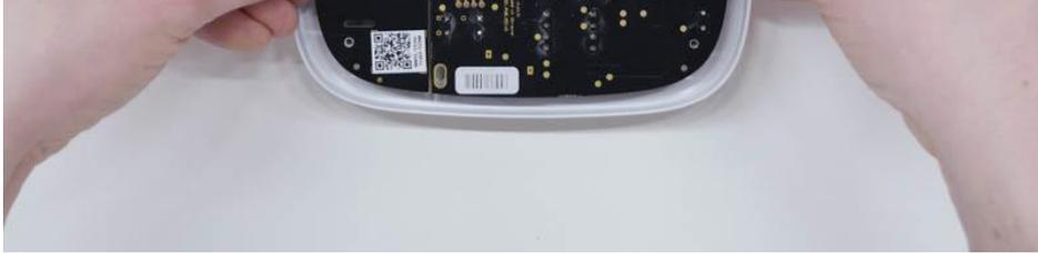
7. Ziehen Sie die (kleinere) Netzteil-Platine von der Hauptplatine ab.
