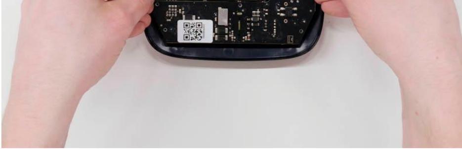
7. Ziehen Sie die (kleinere) Netzteil-Platine von der Hauptplatine ab.
