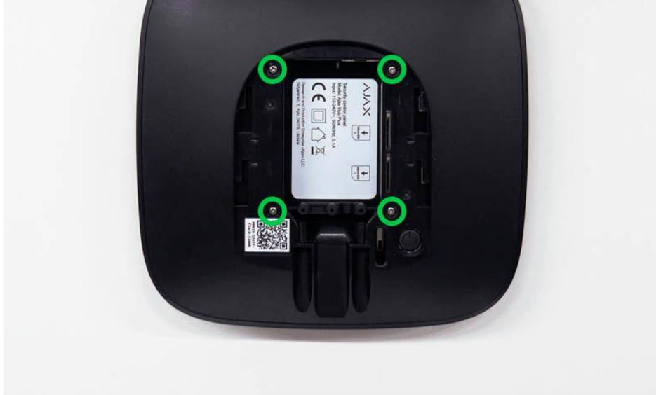
5. Entfernen Sie die Schrauben, mit denen die Platinen am Gerätegehäuse befestigt sind.
