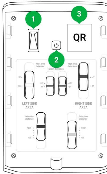
1. Manipulationsschalter: wird ausgelöst, sobald der Melder aus der Halterung genommen oder abgerissen wird
