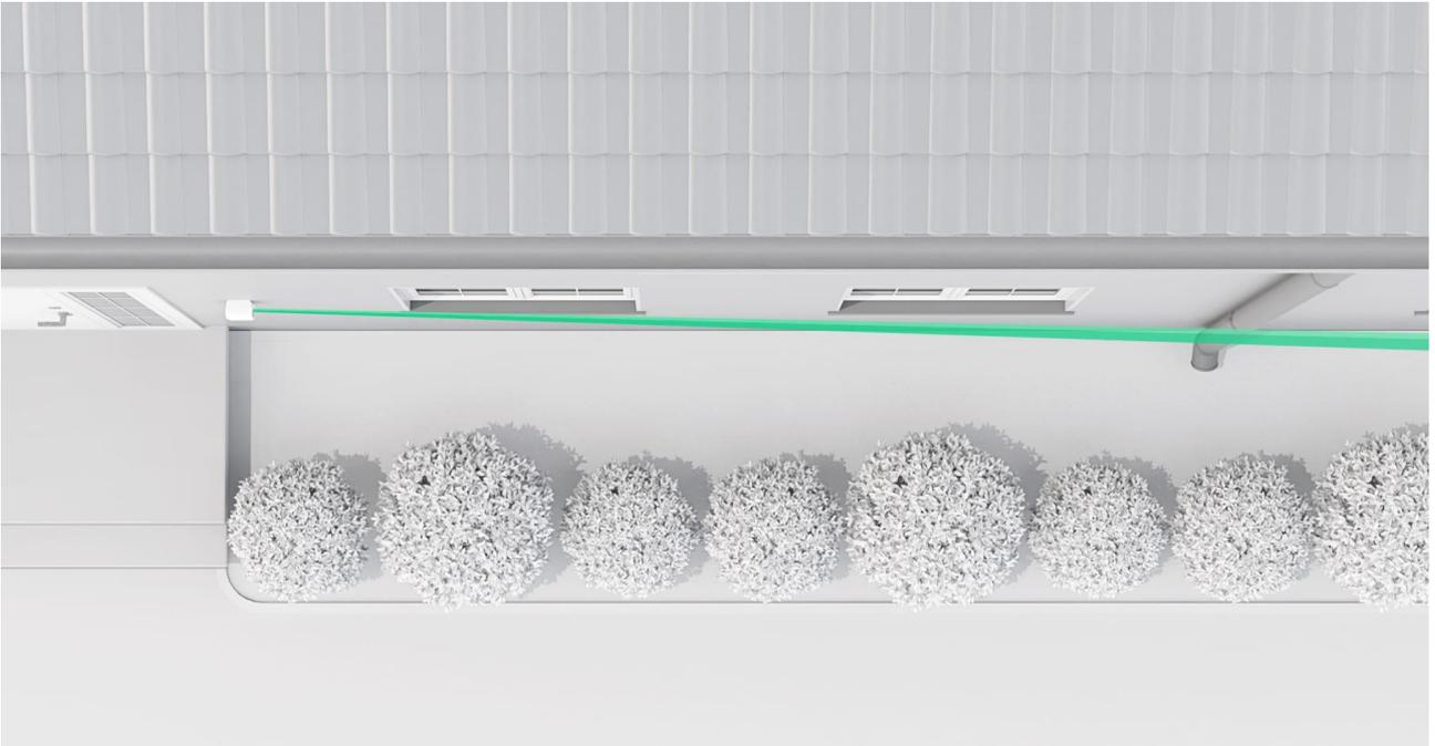
Aktivieren Sie ggf. die **Nahbereichserkennung** (Schieberegler **Near area detection**) für eine gewünschte Seite. Diese Funktion reduziert den blinden Fleck des Melders und ermöglicht daher die Bewegungserkennung von Eindringlingen, die den geschützten Bereich unmittelbar am Melder betreten.
