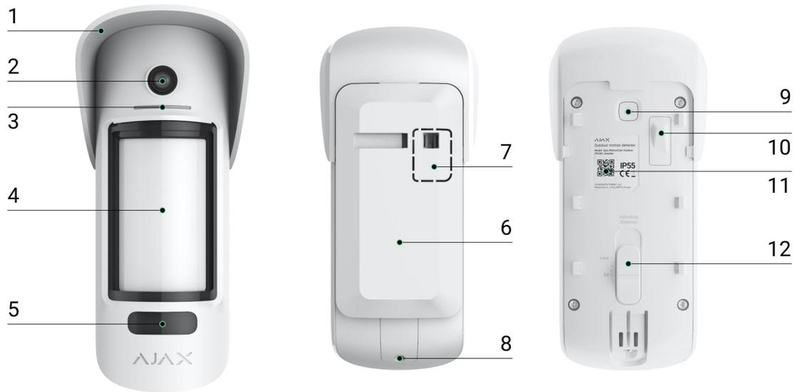
1. Hood zum Schutz der Kamera und der Abdecküberwachungs-Sensoren vor Regen und Schnee.
