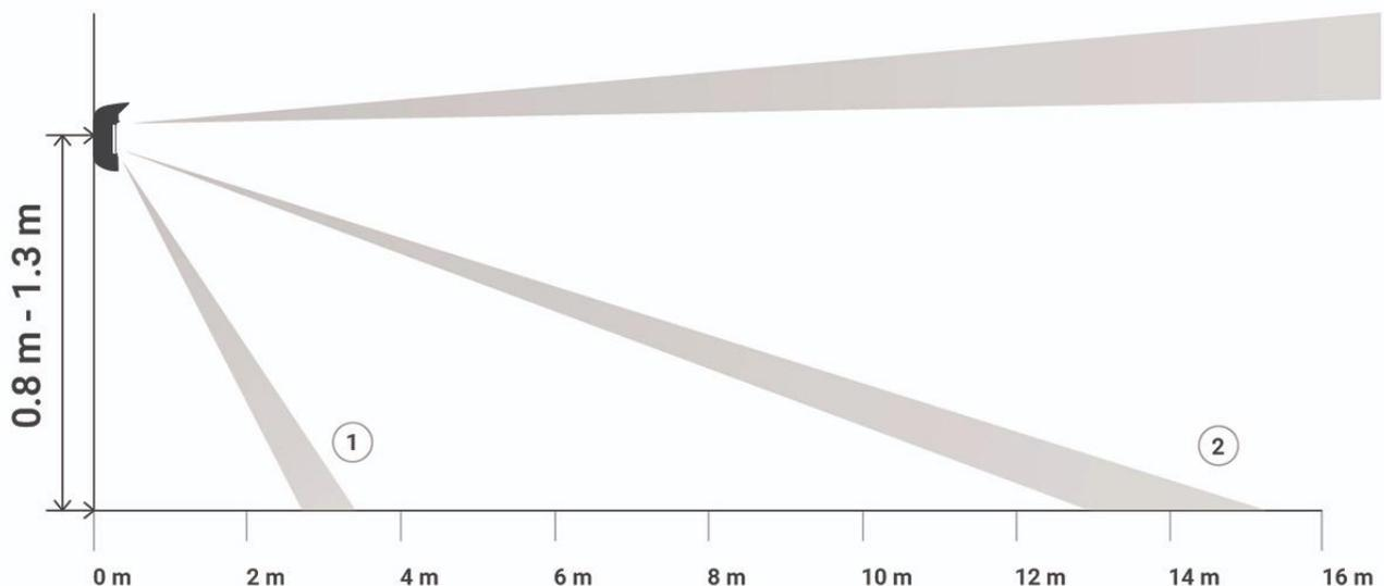
**Zur Erfassung kriechender Einbrecher kann der Melder 50 cm über dem Boden** angebracht werden. Allerdings ist in diesem Fall die Funktion zum Ignorieren von Haustieren nicht verfügbar. Diese Montagehöhe wird bei der Installation von Meldern in Industrieanlagen und Lagerhäusern empfohlen. Wichtig! Tiere dürfen den geschützten Anlagenbereich nicht betreten, da sie sonst Alarme auslösen.
