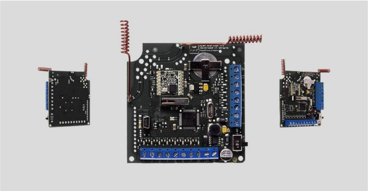
Das Empfängermodul **ocBridge Plus** für Funksensoren ist für den Anschluss kompatibler Ajax-Geräte an eine drahtgebundene Zentraleinheit eines Drittanbieters mithilfe von Öffner-/Schließer-Kontakten vorgesehen. Dank der bidirektionalen Verbindung mit den Sensoren kann das Ajax-System in zwei Betriebsarten arbeiten: Aktiv und Passiv. Im Passiv-Modus wechseln die Funksensoren in den Energiesparmodus, wodurch die Batterielebensdauer erheblich verlängert werden kann.
