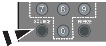
1. Drücken Sie Taste SOURCE auf der Fernbedienung, um zwischen den verfügbaren Quellen zu wechseln.
