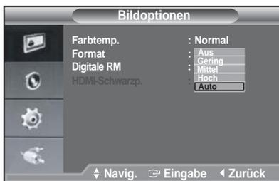
Wenn das Empfangssignal schwach ist, können Sie den digitalen Rauschfilter (Digitale RM) aktivieren, um das Bildschirmrauschen zu reduzieren.
